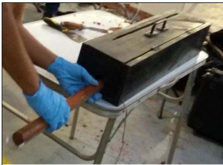
Figura 7- Liner com amostra de solo sendo colocado dentro da caixa preta de luz UV-A (Fonte: Riyis, 2019)
